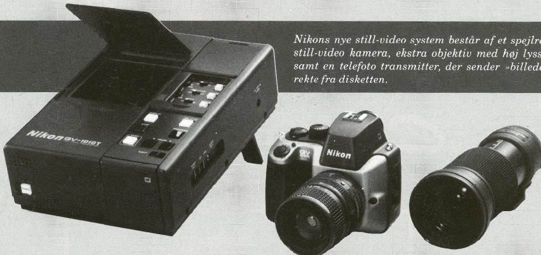
Nikons nye still-video system består af et spejlfleks-still-video kamera, ekstra objektiv med høj lysstyrke, samt en telefoto transmitter, der sender »billedet« direkte fra disketten.
